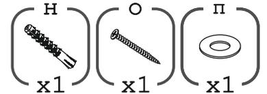
Навесы Scarpi (з,и) зацепить за планки (м) и отрегулировать горизонтальность изделия верхними винтами, после чего притянуть к стене затянув нижние винты. После затяжки нижних винтов необходимо закрепить изделие шурупом (о) с шайбой (п) через ригель (5).
