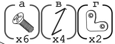
Для упрощения сборки сначала четыре опоры (в) скрепить между собой в две пары при помощи пластины (г) и винтов (а).
