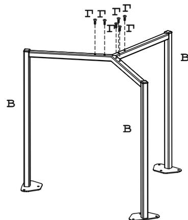
Три опоры (в) соединить между собой винтами (г) через крестовину (д), вставленную внутрь опор (в).
