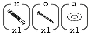
Навесы Scarpi (з,и) зацепить за планки (м) и отрегулировать горизонтальность изделия верхними винтами, после чего притянуть к стене затянув нижние винты. После затяжки нижних винтов необходимо закрепить изделие шурупом (о) с шайбой (п) через ригель (5). Бурение отверстия и установку дюбеля (н) проводить через отверстие  $\varnothing 10\text{мм}$  в ригеле (5).
