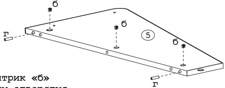
Установить эксцентрик «б» стрелкой в сторону отверстия на торце детали.
