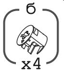
Установить эксцентрик «б» стрелкой в сторону отверстия на торце детали.
