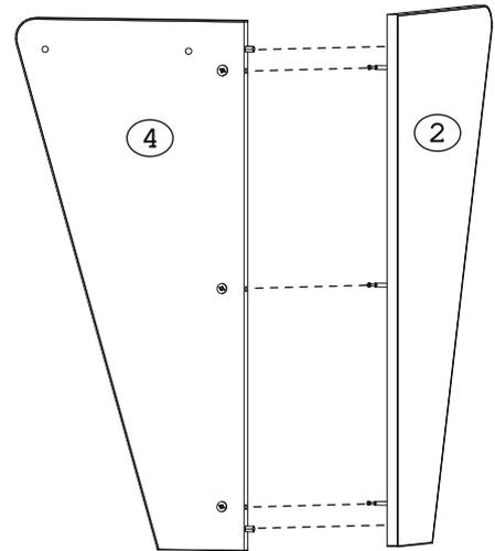
Соединить деталь 2 с деталью 4 и деталь 3 с деталью 5. Затянуть эксцентрики «б» поворотом по часовой стрелке.
