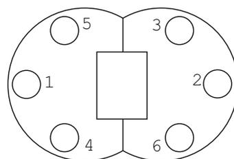
Сначала производить предварительную протяжку, затем окончательную
