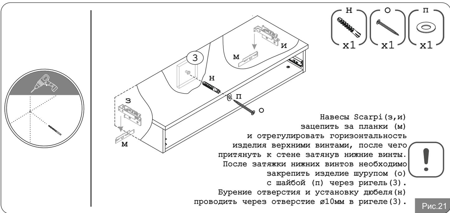
Навесы Scarpì (з,и) зацепить за планки (м) и отрегулировать горизонтальность изделия верхними винтами, после чего притянуть к стене затянув нижние винты. После затяжки нижних винтов необходимо закрепить изделие шурупом (о) с шайбой (п) через ригель (з). Бурение отверстия и установку дюбеля (н) проводить через отверстие  $\varnothing 10\text{мм}$  в ригеле (з).
